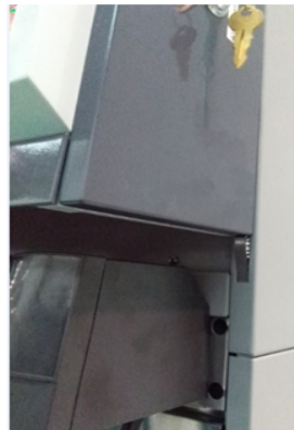
弹簧支架支撑灯箱 拆除4颗螺钉
